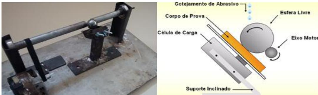
Figura 2 - Máquina de Ensaio de Desgaste por Esfera Livre (esquerda) e Esquema de funcionamento do Ensaio (direita)
