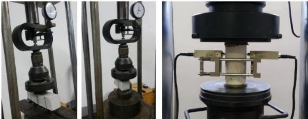
Figura 1: Determinação da resistência e módulo de deformação das argamassas.
