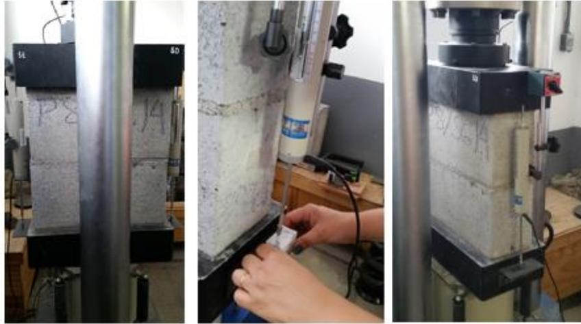
Figura 2: Determinação da resistência à compressão e módulo de deformação dos prismas.
