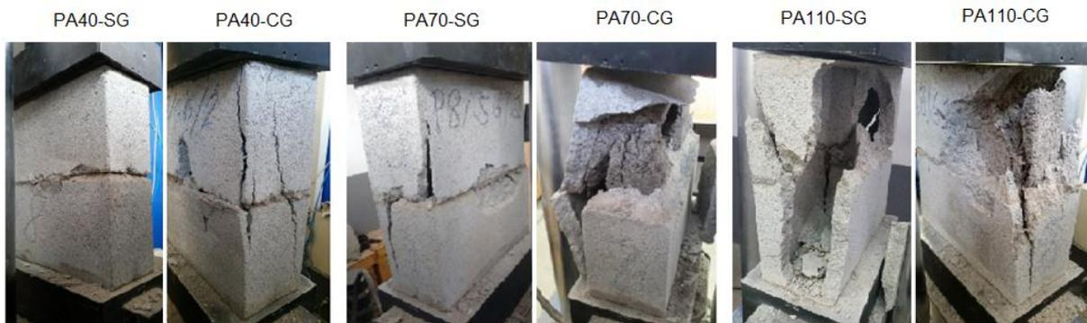
Figura 3: Mecanismos de ruptura observados para os diferentes lotes de prisma.
