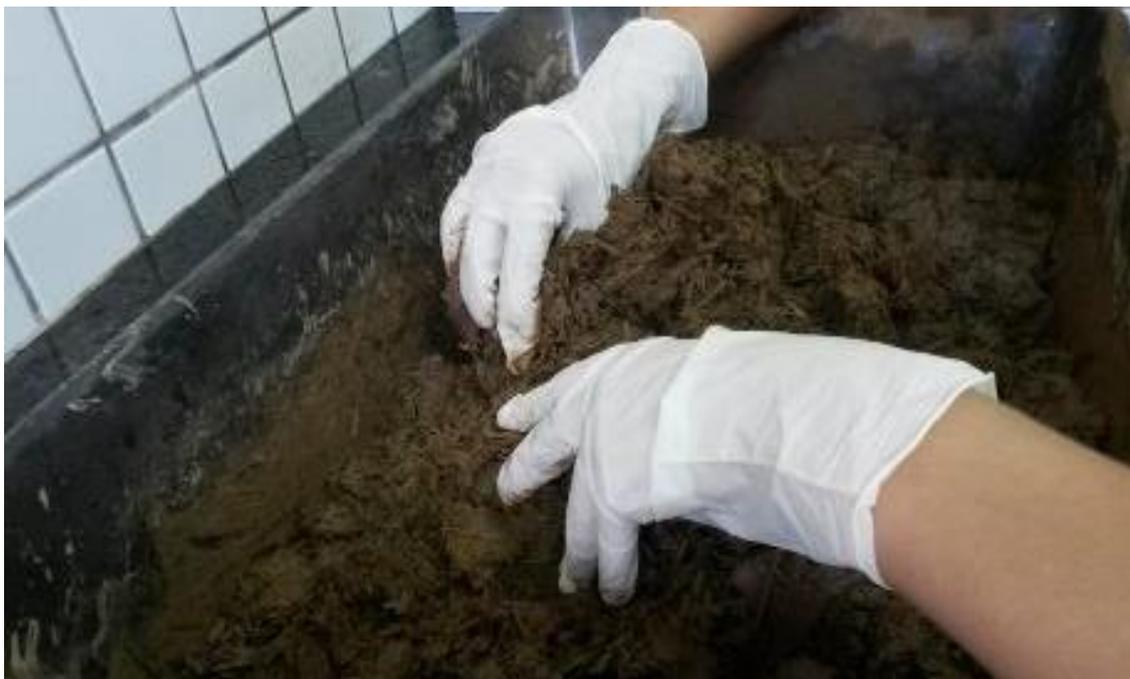
Figura 1 - Amassamento da mistura de barro e palha com as mãos.
