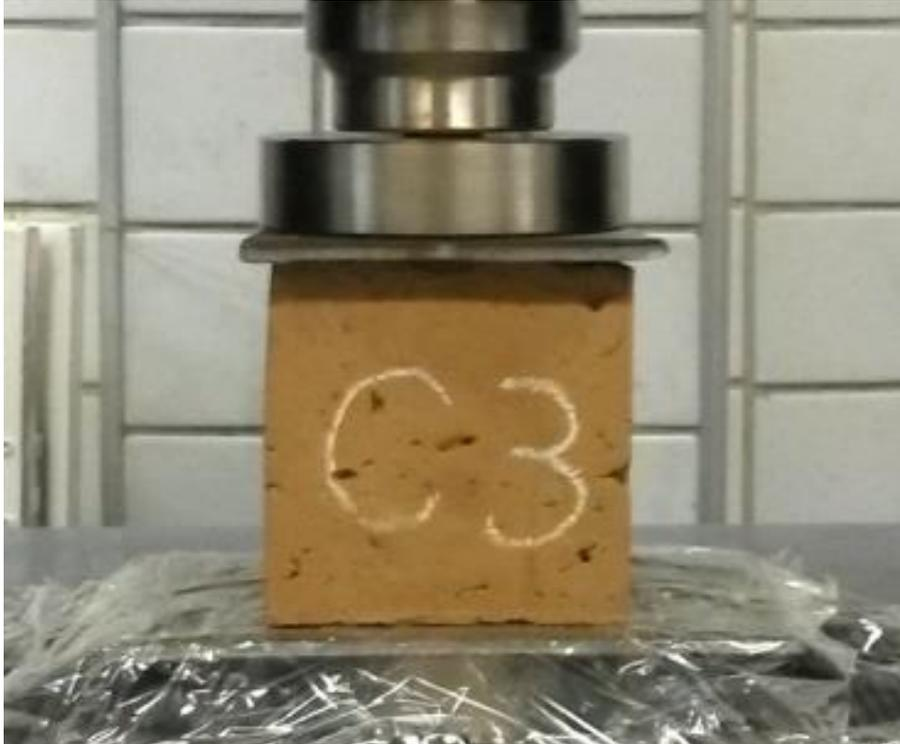
Figura 3 - Chapas de ferro para apoiar e distribuir igualmente a carga aplicada.
