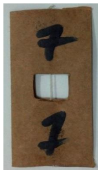
Figura 2. Modelo de corpo de prova para ensaio individual da fibra.
