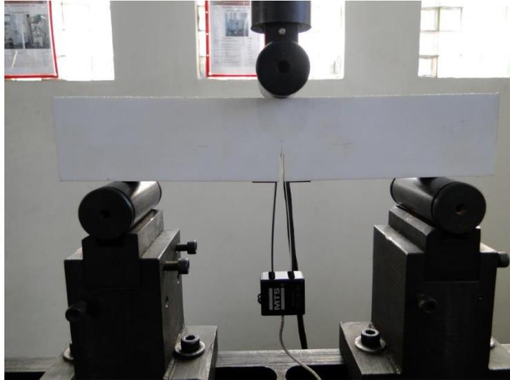
Figura 3: Ensaio para a obtenção da curva J-R com flexão em três pontos
