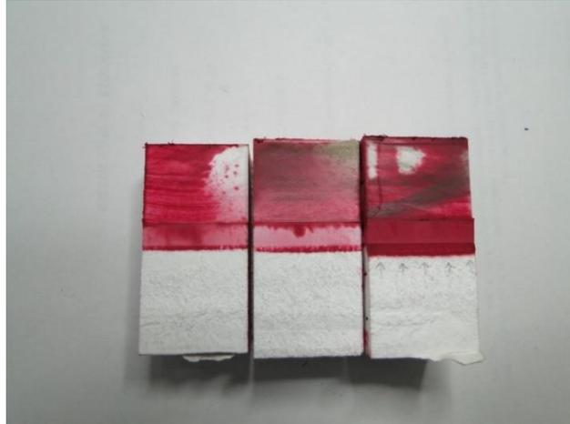
Figura 4: Amostras pós-fadigadas com líquido revelador indicando o crescimento da trinca
