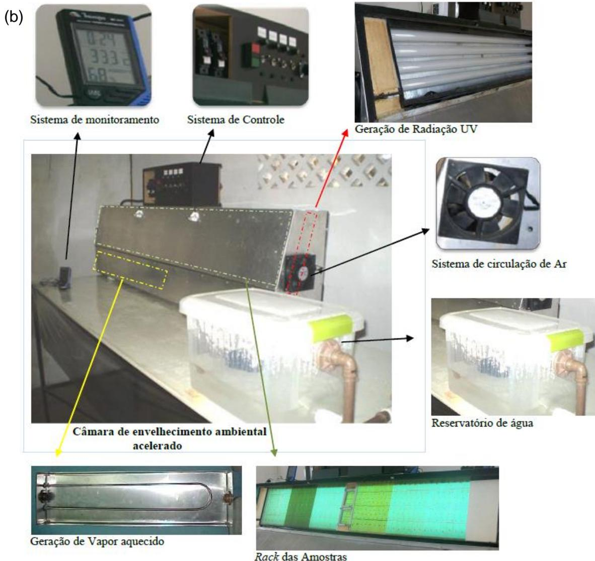
Fig. 2. Câmara de envelhecimento ambiental com detalhe de seus componentes.
