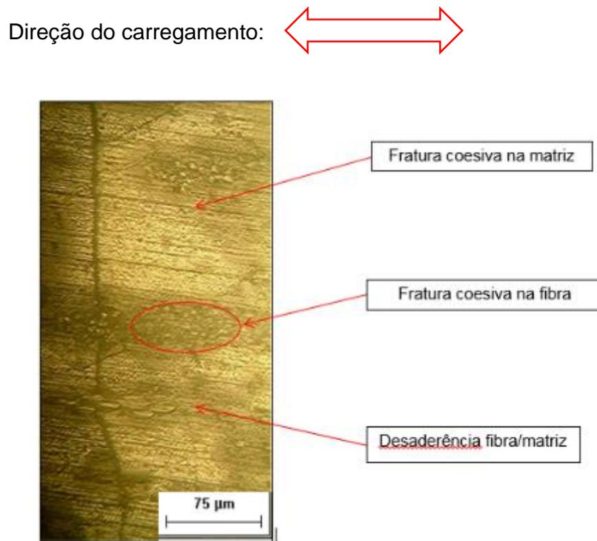
Figura 06 – Característica da fratura do CP de tração – Envelhecido.
