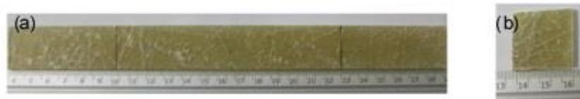
Figura 02- Corpos de prova a) para o ensaio de tração uniaxial, b) para ensaio de densidade.
