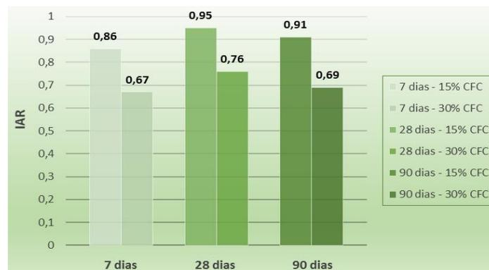
Figura 6 – Índice de atividade resistente para argamassas com diversos teores de CFC
