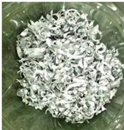
**Figura 1.** Cavacos de alumínio usados para fabricar o nanocompósito
