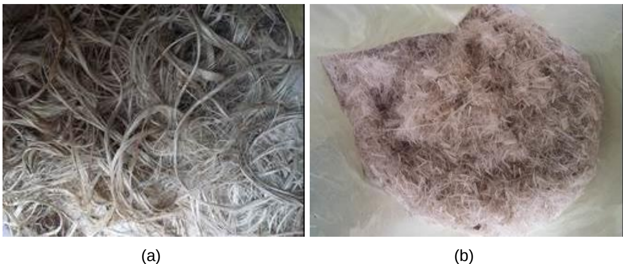
Figura 1 – Fibras de malva longas, como recebidas (a), e cortadas em torno de 5 mm (b)
