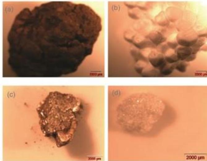
Figura 5: Microscopia da: (a) argila expandida, (b) poliestireno expandido - EPS, (c) vermiculita e (d) perlita expandida.
