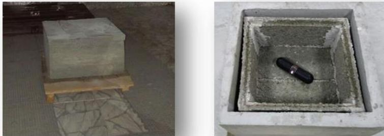
Figura 6 – Sistema caixa EVA/cimento dentro da caixa de concreto com som MP3 dentro.
