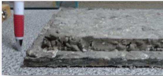
Figura 4 – Detalhe do encaixe macho-fêmea
