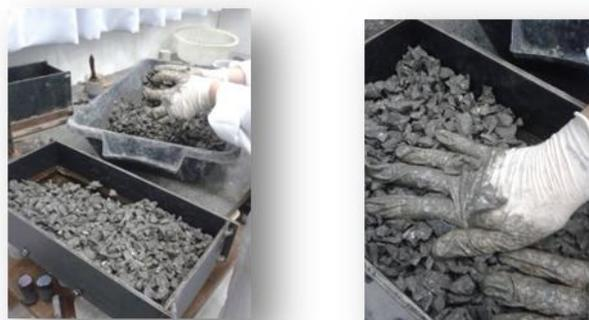
Figura 2 - Mistura dos materiais, e colocação do mesmo na caixa molde
