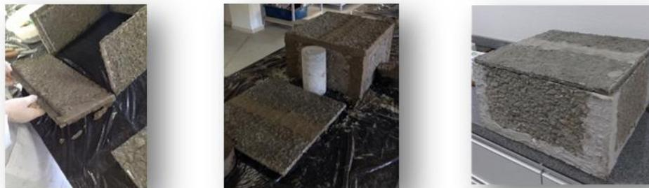
Figura 5 – Montagem da caixa produzida a partir das placas EVA/cimento
