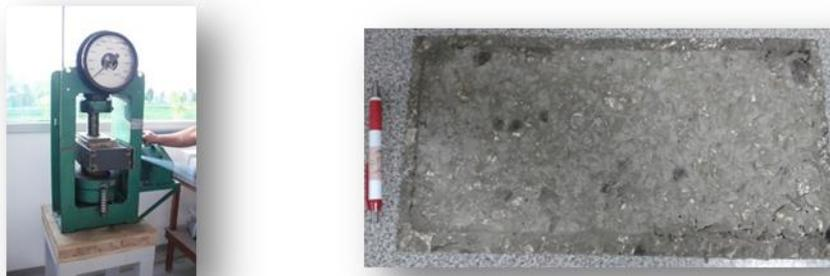
Figura 3 - Aplicação de 5 toneladas e placa pronta após 24 horas
