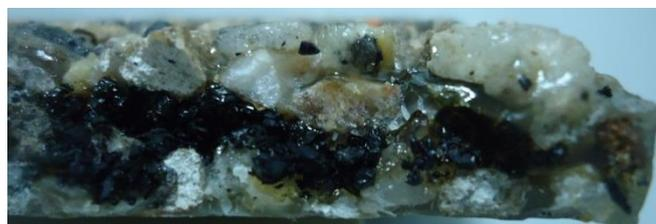
Figura 4. Seção transversal de uma placa fraturada no ensaio de flexão.
