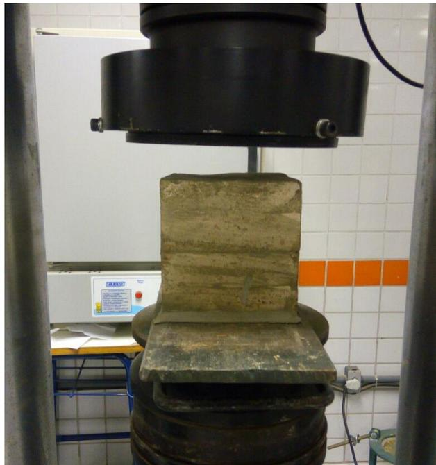
Figura 03: Ensaio de rompimento do bloco composto de gesso e resíduos da construção civil.
