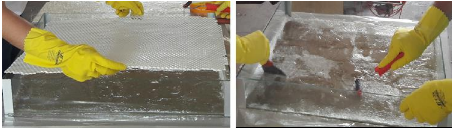
Figura 3: Confeção do compósito pelo método hand lay-up .
