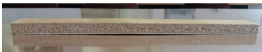
Figura 4. Corpo de Prova (P8G) após o rompimento no ensaio de flexão estática.
