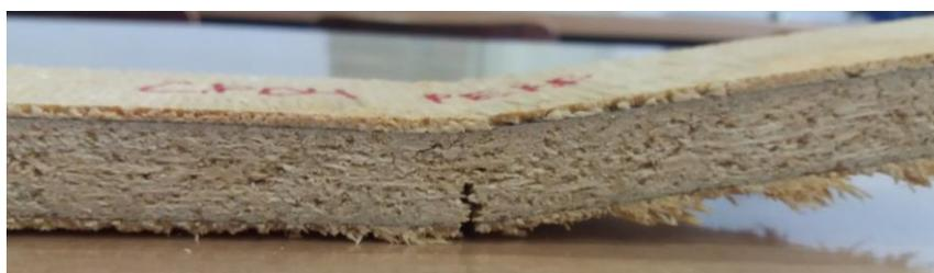
Figura 5. Corpo de Prova (MDP sem uso) após o rompimento no ensaio de flexão estática.
