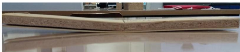
Figura 3. Corpo de Prova (P4G) após o rompimento no ensaio de flexão estática.
