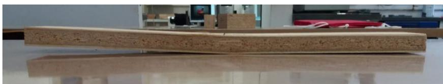
Figura 6. Corpo de Prova (PH) após o rompimento no ensaio de flexão estática.
