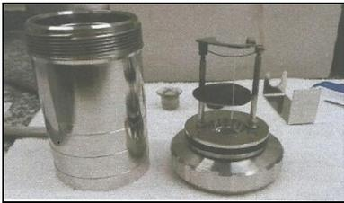
Figura 2: Bomba calorimétrica
