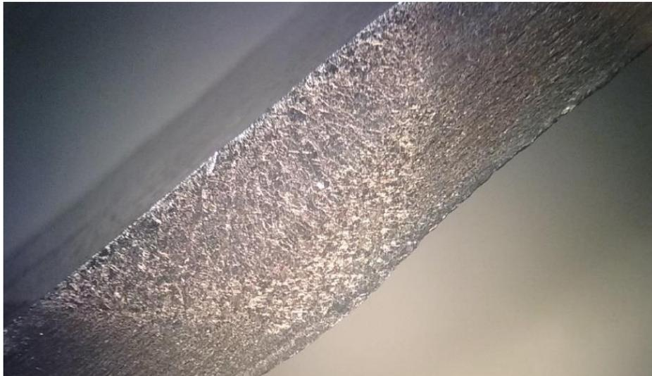
*Figura 8 - Aspecto do material incluindo MB e região afetada pela soldagem multipasse após ensaio de corrosão*
