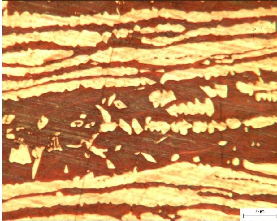
Figura 2 - Micrografia do Metal Base: austenita e ferrita (fase escura)
