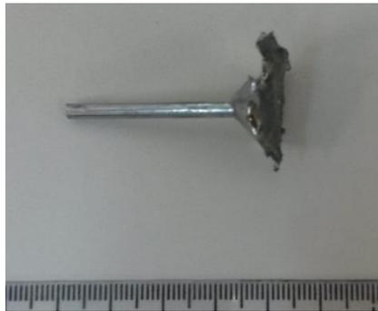
**Figura 2** – Amostra cilíndrica de 3 mm de diâmetro por 50 mm de comprimento, da composição  $(\text{Cu}_{47}\text{Zr}_{45}\text{Al}_8)_{98}\text{Y}_2$  antes da preparação para soldagem.
