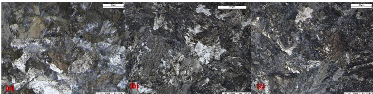
Figura 1 - Microestruturas dos aços (a) S; (b) P1; (c) P2 - MO - 500x - Nital 2%.
