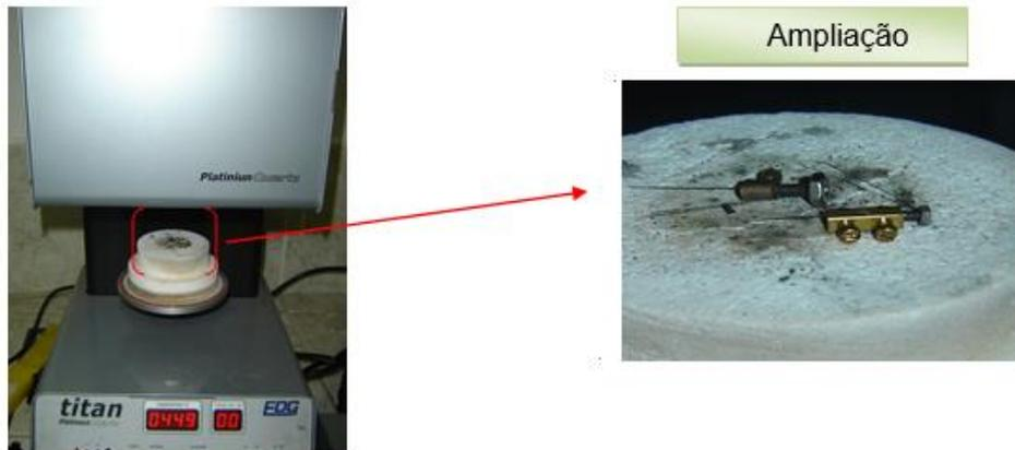
Figura 2. Forno para tratamento térmico da mola e ampliação.
