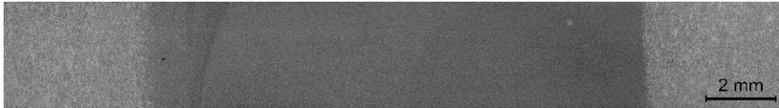
Figura 3. Superfície de topo da junta soldada de Inconel 625.
