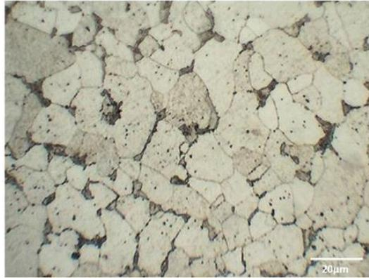
Figura 3- Microestrutura normalizada natural com aumento de 50x
