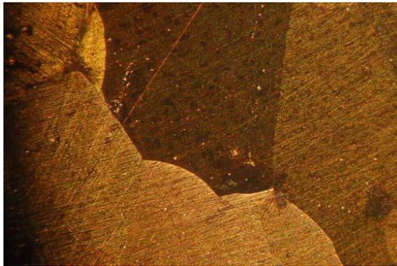
Figura 2: Microestrutura da LMF CuAlBe (16,5x). A base da micrografia das figuras 1 e 2 correspondem a  $1500 \mu\text{m}$ .
