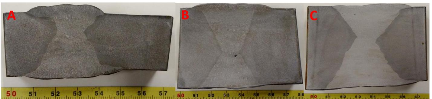
Figura 2 – macrografia dos corpos de prova na secção transversal da chapa. Reagente químico utilizado: Nital 2%. a) espessura 25 mm; b) 50 mm e c) 75 mm.
