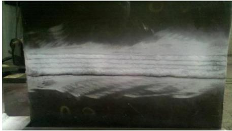
Figura 1 – Ensaio de líquido penetrante na superfície da solda.
