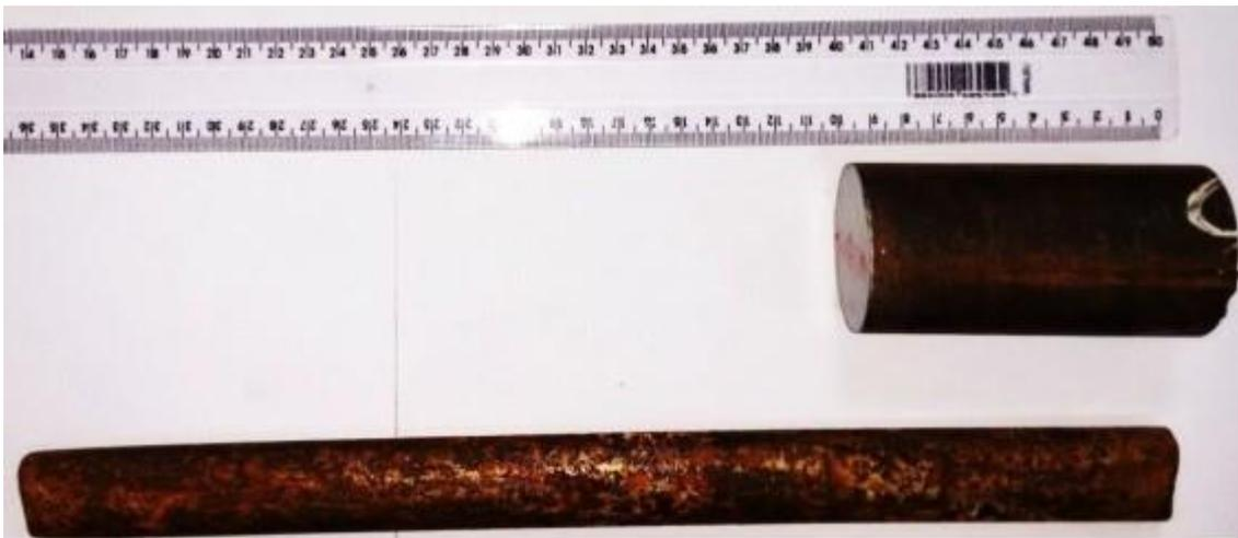
Figura 1: Barras fornecidas para análise. Segmento 1 antes do uso e segmento 2 depois do uso, apresentando desgaste acentuado.
