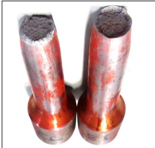
Figura 8. Amostra jateada - fratura dúctil.
