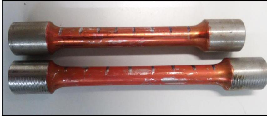
Figura 9. Amostra trefilada após ensaio de tração.
