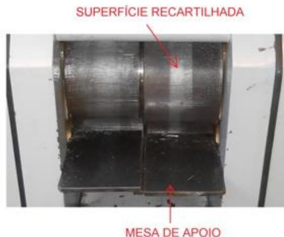
FIGURA 1 - Detalhe da superfície recartilhada e mesas de apoio
