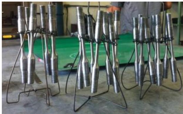
Figura 2: CP's dispostos no suporte, preparados para sofrer o tratamento térmico.
