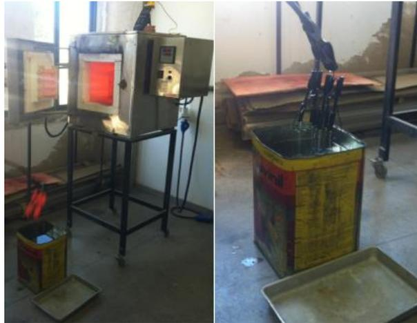
Figura 3: CP's submetidos à têmpera.
