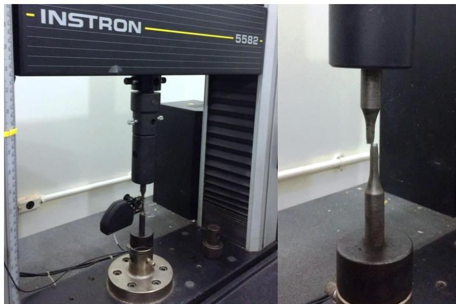
Figura 6 - Ensaio tração com extensômetro (à esquerda) e CP fraturado, ainda na Instron (à direita).
