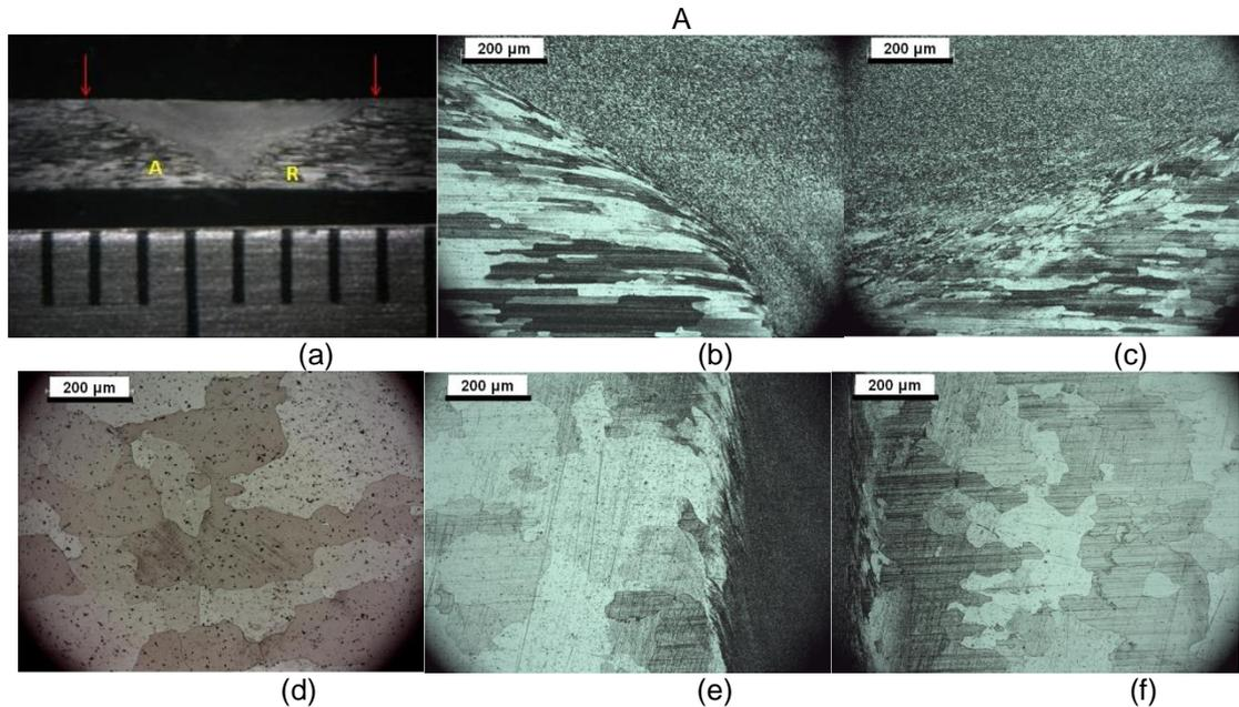
Figura 1 apresenta micrografia (secção transversal e superfície) da amostra soldada, destacando a região da zona misturada (*nugget*), a qual sofre recristalização. Nesta região, os grãos são equiaxiais, diferentemente da região do material não afetada pelo processo FSW (grãos alongados na direção de laminação). Além da alteração na morfologia dos grãos, a literatura afirma que cada região responde de maneira diferenciada à corrosão<sup>(7)</sup>.
