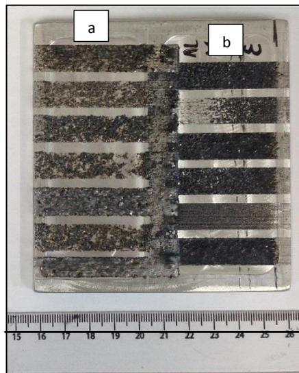
Figura 1 - Recobrimentos da liga  $Al_{71}Co_{13}Fe_8Cr_8$  após serem tratados por laser cladding em substrato de alumínio: a) trilhas sobrepostas do pó atomizado e b) trilhas sobrepostas do pó moído.
