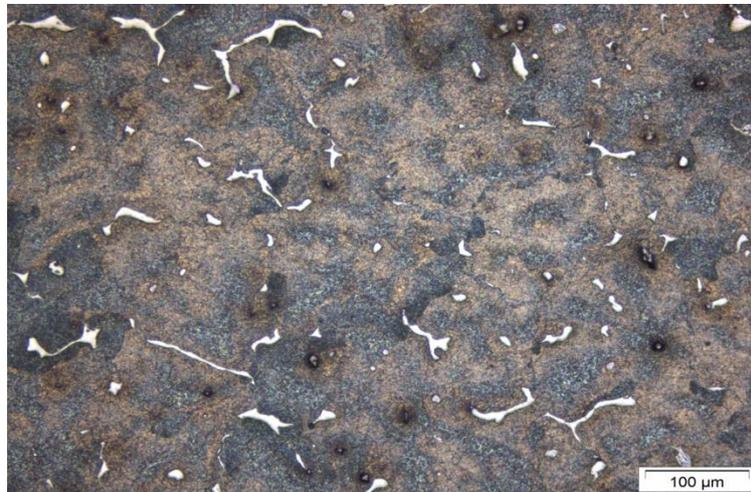
Figura 4 – Microestrutura da amostra de AZ91D fornecido.
