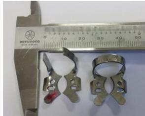
**Fig. 2 – Grampo fraturado (esquerda) e um grampo do mesmo tipo sem fratura (direita).**
