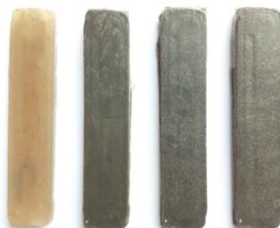
Figura 3: Corpos de prova ordenados com adição de pó de mármore com granulometria em ordem crescente.
