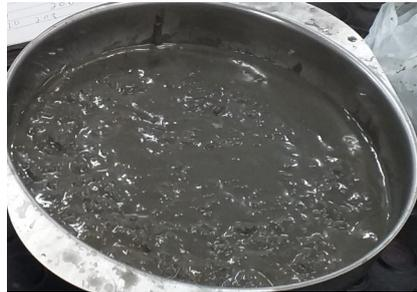
Figura 2: Coleta da lama gerada no processo de beneficiamento do mármore.
