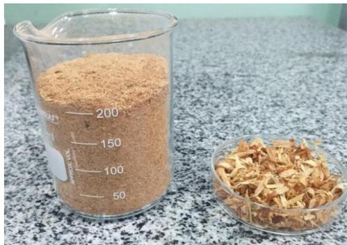
Figura 1: Serragem de madeira em pó e serragem de madeira em lascas.
