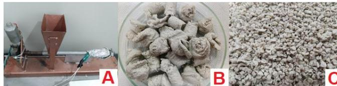
Figura 2: Extrusora monorosca (A); Blocos poliméricos (B); Pellets (C).
