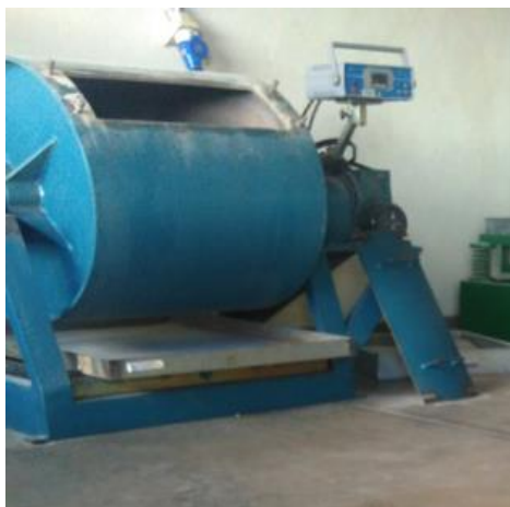
Figura 2: Moinho para grãos maiores – laboratório Geotecnia – CAP/UFSJ.
