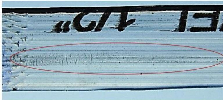
Figura 4: Corpo de prova ensaiados sob tração, em contato com a solução de hidróxido de sódio com concentração de 5M.
