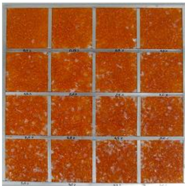
Figura 1: PET distribuído nas cavidades com os diferentes níveis de contaminação por PVC.
