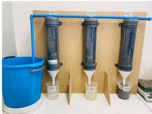
Figura 1 – Sistema de lixiviação colunar utilizado na filtração dos resíduos
