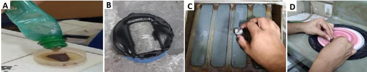
Figura 3: Embutimento em Resina Epoxy (A); Embutimento em Massa Plástica (B); Lixamento (C); Polimento (D)
