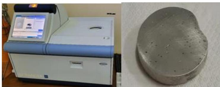
Figura 2: Equipamento de FRX modelo S2 RANGER da Burker, e Amostra de Al-2,7Si
