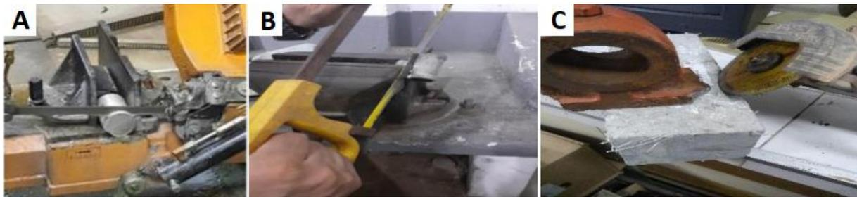
Figura 1: Corte de Tarugo de Al-2,7Si em Serra Fita (A); Corte de Curva Hidráulica por Serra Manual (B); Corte do canto do Mancal por Disco Abrasivo (C)
