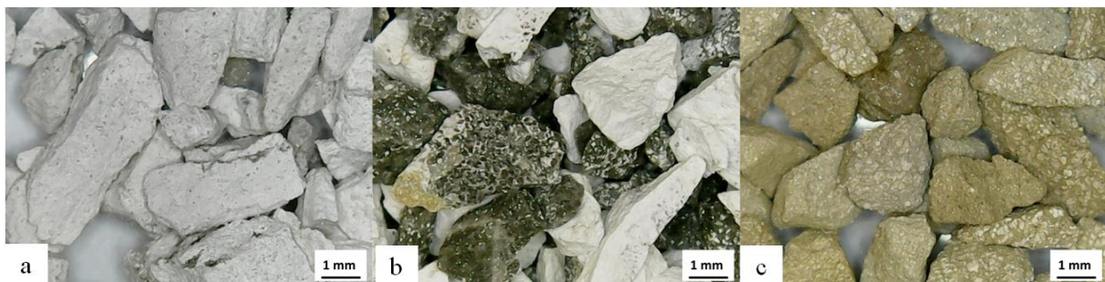
Figura 7 – Partículas calcinadas durante os 15 minutos iniciais das amostras de calcário a 1.423,1 K (1.150 °C): (a) Piauí, (b) Bambuí e (c) Cumbe.
