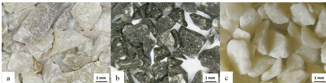
Figura 2 – Características da forma de partículas das amostras de calcário preparadas para os ensaios de calcinação: (a) Piauí, (b) Bambuí e (c) Cumbe.
