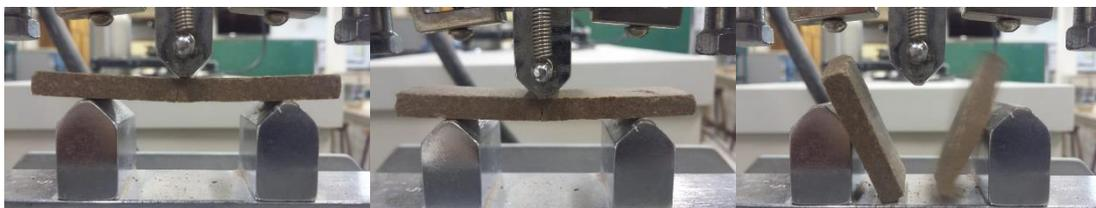
Figura 2: Amostra submetida ao ensaio de resistência mecânica à flexão a três pontos.
