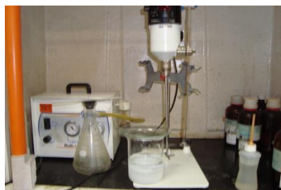
Figura 1 – Esquema utilizado para a coprecipitação dos íons metálicos.
