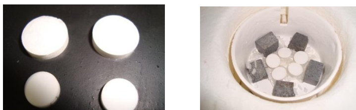
Figura 9 – Amostras de espinélios utilizadas nos testes de sinterização via forno convencional (a) e microondas (b).
