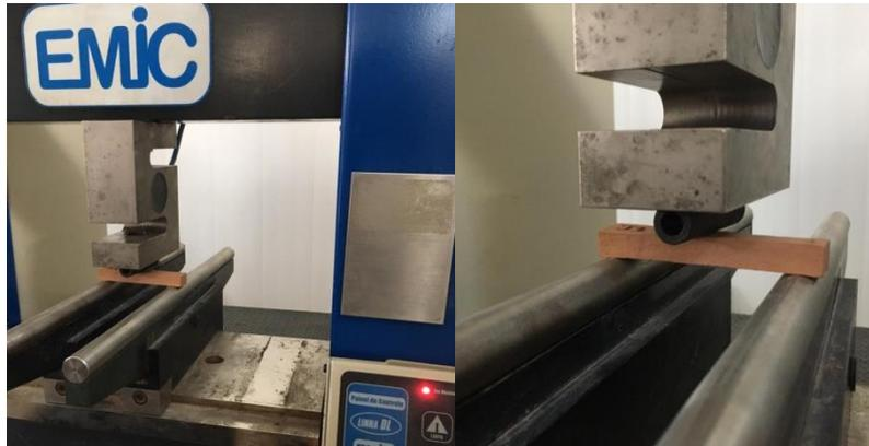
Figura 3: Execução do ensaio de flexão em três pontos
