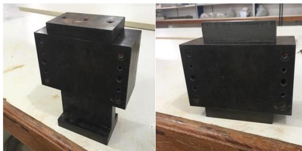
Figura 1: Molde para confecção dos corpos de prova
