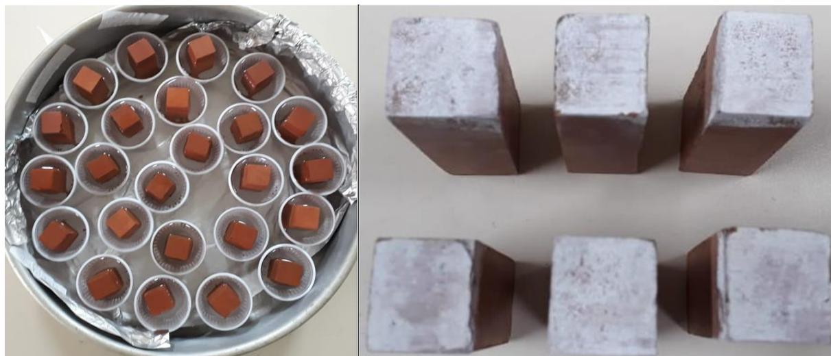
**Figura 2** – Amostras imersas em água (esquerda) para a formação de eflorescência (direita).
