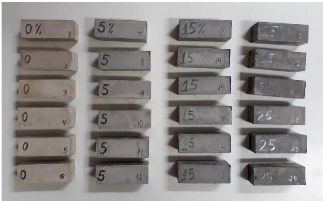
**Figura 1** – Coloração dos corpos de prova a verde com diferentes teores de resíduo (%m.).
