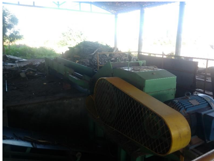
Figura 02. Equipamentos necessários para tritura a madeira.
