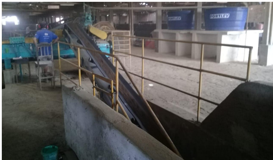
Figura 4 – Argila sendo transportada até o misturador. Fonte: Própria do autor
