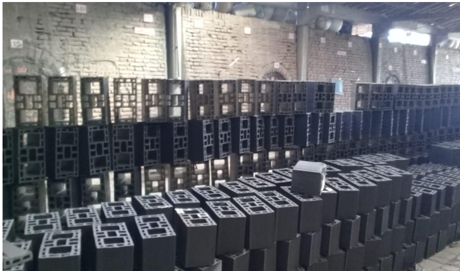
Figura 5 – Secagem dos blocos cerâmicos. Fonte: Própria do autor.
