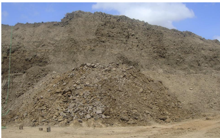
Figura 2 – Armazenagem das argilas para sazonalização. Fonte: Própria do autor.
