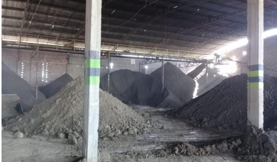
Figura 3 – Preparação da argila. Fonte: Própria do autor.
