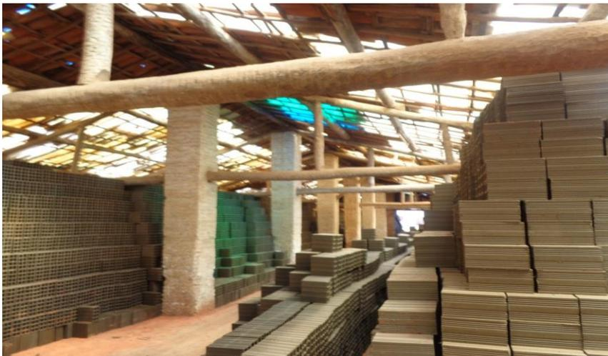
Figura 6. Galpões construídos de telhas transparentes e secagem natural.
