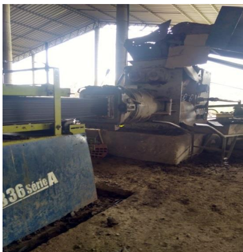
Figura 05- Moldagem (extrusão) do tijolo.
