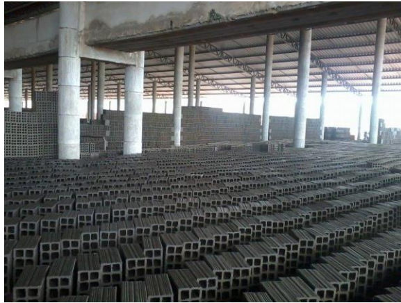
Figura 06- Secagem dos blocos de forma natural.
