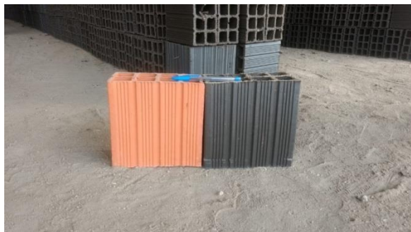
Figura 07- Tijolo antes e depois da queima.
